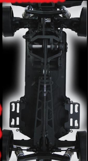
フロントベルトとリアベルトを車両の中心に配置する事でアクセルON/OFF時に発生する左右の動きの違いが無い為、初心者からエキスパートまで素直なコントロール性能をお楽しみ頂けます。
